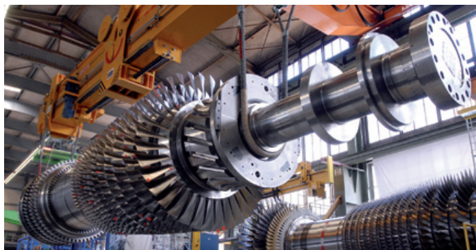
Weltrekordhalter in Sachen Energieeffizienz: Die Gasturbine von Irsching (© Siemens-Pressbild)
