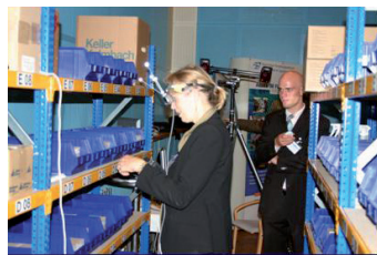
ForLog verbesserte die Kommissionierung im Lager mit Hilfe einer Augmented Reality-Umgebung. Die Mitarbeiterin sieht den Auftrag direkt in der „Brille“.
