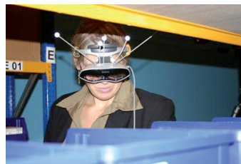
ForLog verbesserte die Kommissionierung im Lager mit Hilfe einer Augmented Reality-Umgebung. Die Mitarbeiterin sieht den Auftrag direkt in der „Brille“.
